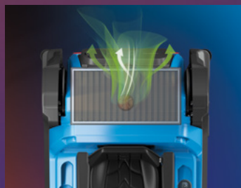
Filtre HEPA air en sortie
